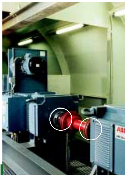
Bild 25: Lagerlose Digital-Tachos HG 18 synchronisieren zwei über eine Kardanwelle gekoppelte DC-Getriebemotoren.
