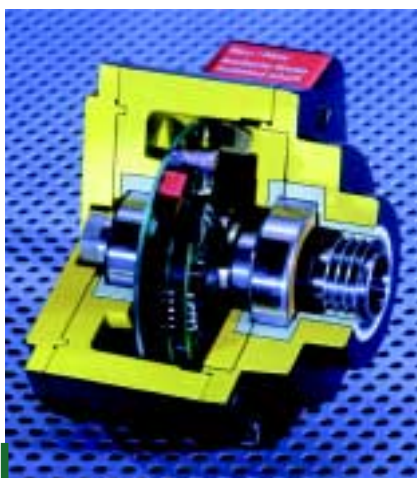
Bild 22: HeavyDuty®-Technik in Höchstform: massives Leichtmetallgehäuse, reichlich dimensionierte, isoliert eingebaute Kugellager, Abtastelektronik mit Leistungstransistoren zwischen den Lagern, Labyrinth-Dichtung für Schutzart IP 66 (HOG 10).
