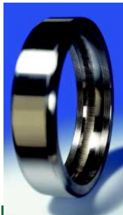
Bild 23: Von Wellenströmen geschädigte Kugellager sind durch eine riefelförmige Lauffläche gekennzeichnet.
