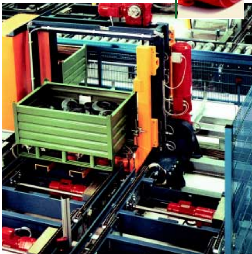
Fahrerlose Transportsysteme steuern präzise ihr Ziel an: HÜBNER Digital-Tachos HOG 71 erfassen die Drehzahl der miteinander vernetzten Getriebemotore.
